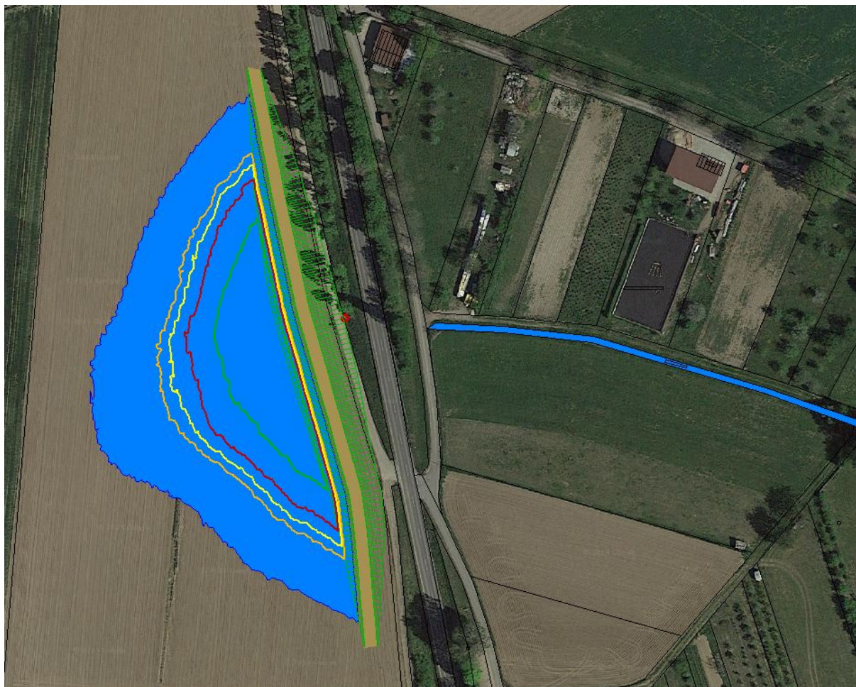
Abbildung 5: Einstauflächen versch in rot Einstaufläche HQ1, in orange Einstaufläche HQ5, jeweils bei Q_{dr} = 100 \text{ l/s} , in grün Einstaufläche HQ1, in gelb Einstaufläche HQ5, jeweils bei Q_{dr} = 400 \text{ l/s}
