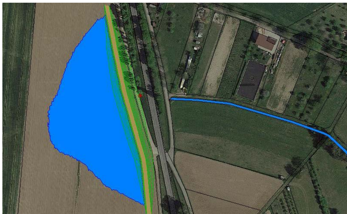
Abbildung 3: Potentieller Rückhalteraum Läufelbergboden (blaue Fläche).
